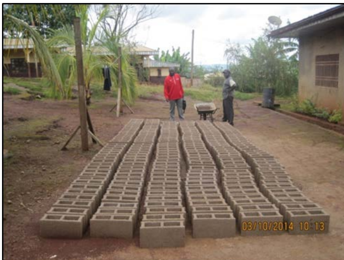
Production des agglomérés de ciment (parpaings)
